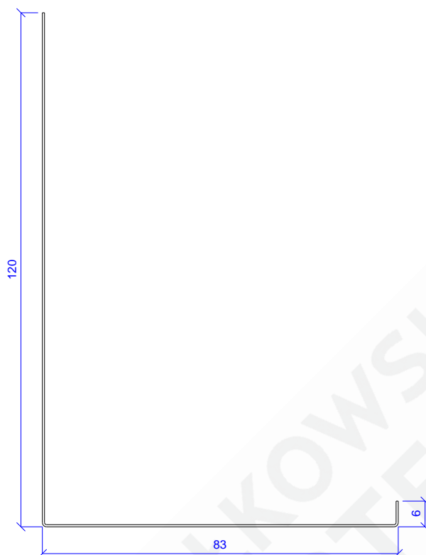
Rys. 6 – MARC–D60-01.05.00 [Maskownica ościeżnicy]
