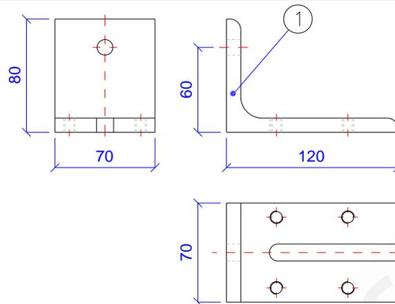
**Fig. 5 – MARC-P(1)60-01.03.00 [Truck rail bracket]**
