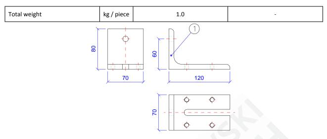
Fig. 5 - MARC-P(1)60-01.03.00 [Truck rail bracket]
